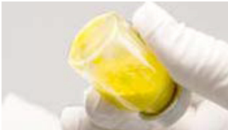
Ikke opslæmmet: Synlige klumper
